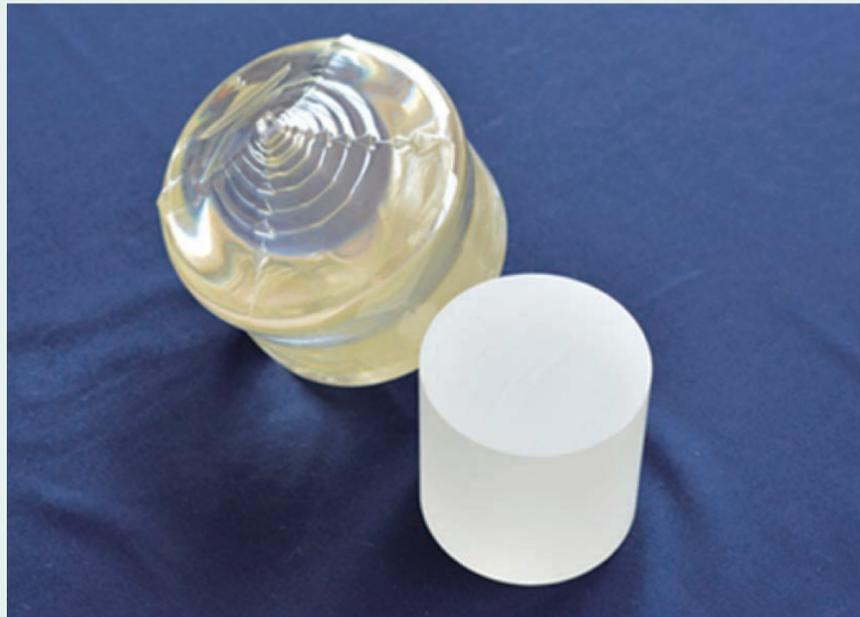
オプトエレクトロニクス材料として、複屈折を利用した光学ローパスフィルタ(OLPF)、非線形光学効果を利用した導波路型光変調素子、SHG素子、光スイッチ等の材料に使用されています。耐光損傷性を向上させたZnOドープ、およびMgOドープ LiNbO<sub>3</sub> の製造が可能です。
